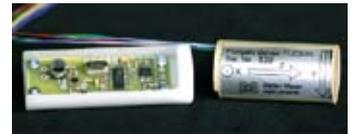
Bild 4: Fluxgate Sensor mit Auswertelektronik der Hochschule Offenburg.
