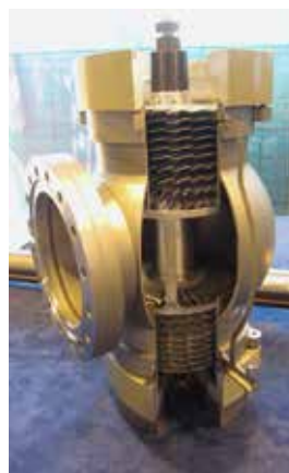
Aufgeschnittene Turbomolekularpumpe zum Evakuieren
