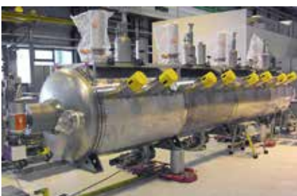
Supraleitende Beschleunigungskavität, die bereits in einen Vakuumbehälter eingebaut ist
