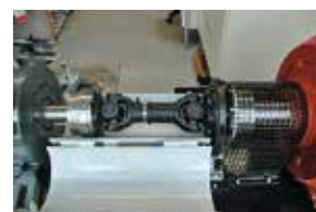
Detailansicht der Drehmomentmesswelle (unter dem Gitter) und der Gelenkwelle
