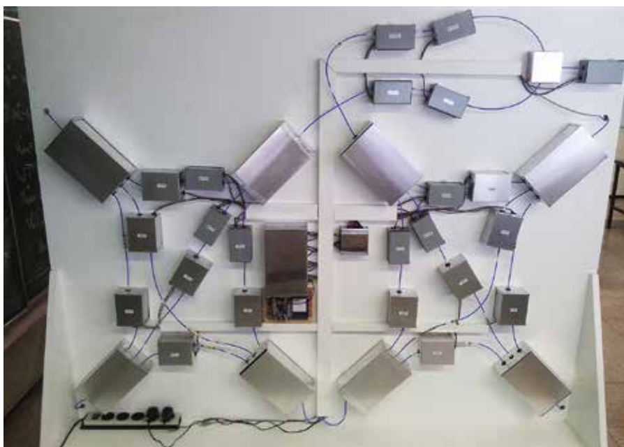
Im Rahmen des EU-Verbundprojekts „WiMBex“ wird gegenwärtig ein Teststand entwickelt, auf dem die Netzprotokolle der energieautarken Funkknoten verifiziert und qualifiziert werden können
