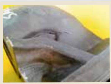
Links: mit einem mechanismenbasierten Modell berechnete kritische Stelle (rot) eines Abgaskrümmers; rechts: im Bauteilversuch ermittelte kritische Stelle (Riss) des Abgaskrümmers
