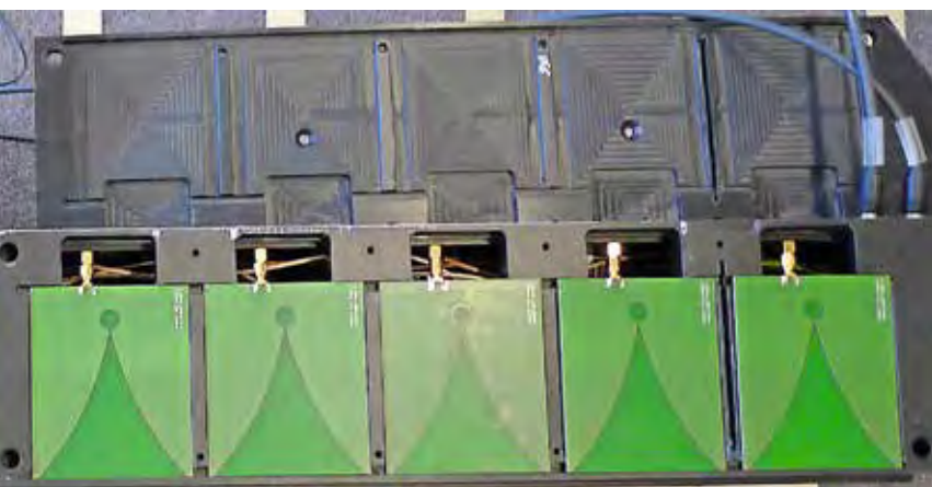
Antennen-Array für Sende- und Empfangssignale
