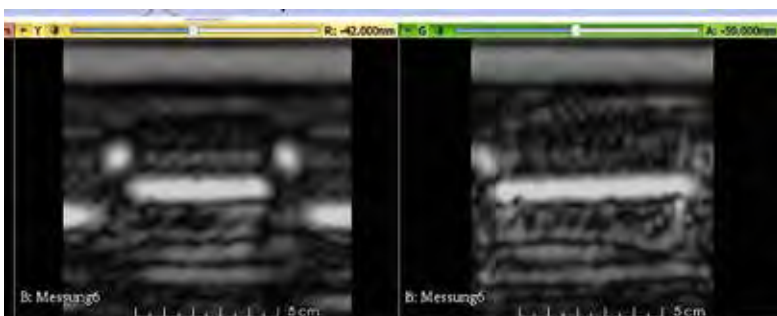
Radar-Scan eines Betontrögs
