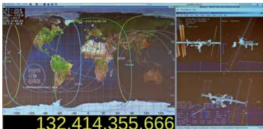
Alpha-Magnet-Spektrometer (AMS) auf der ISS. Die gelbe Zahl stellt die Anzahl der untersuchten Teilchen dar
