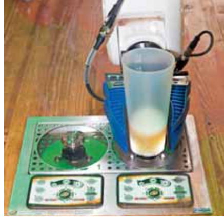
Bier zapft O'Barro von unten, dadurch schafft er 30 Becher in einer Minute
