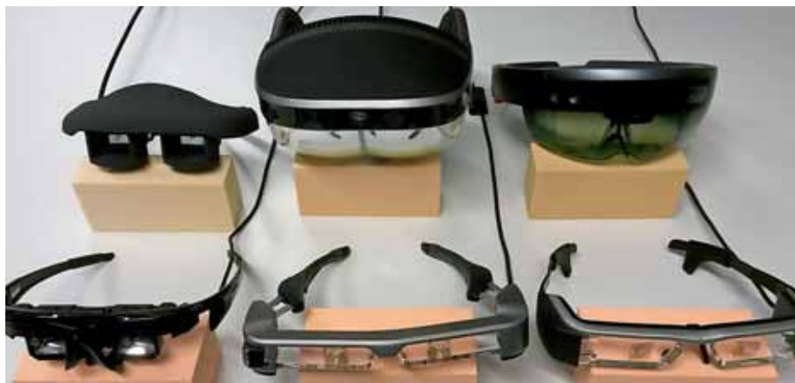
Abbildung 2: Eine Auswahl der am Labor CompAssMed zur Verfügung stehenden Optical-See-Through Head-Mounted-Displays: Prototyp Fraunhofer-Institut, Meta 2, Microsoft Hololens, Vuzix Star 1200XLD, Epson Moverio BT-200 und BT-35E (von oben links nach unten rechts)
