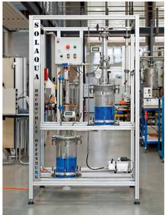
Abbildung 2: Funktionsmodell SolAqua im Technikum des Studiengangs Verfahrenstechnik
